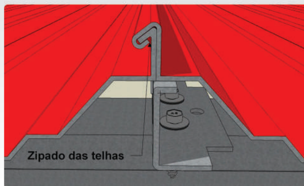
Zipado das telhas
